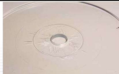
Cracking causato da viti nel policarbonato e CR-39
